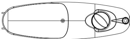
Impostare il termostato su una posizione centrale al fine di garantire una temperatura ottimale per il suo normale funzionamento. Ruotando la manopola del termostato in senso orario si riduce la temperatura all'interno dell'apparecchio. Ruotando la manopola del termostato in senso antiorario, si aumenta la temperatura all'interno dell'apparecchio.
