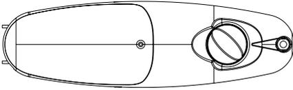
Placera den i ett centralt läge för att ställa in en optimal temperatur för normalt bruk. Ju mer du vrider ratten medurs, desto lägre blir kylskåpstemperaturen. Ju mer du vrider ratten moturs, desto högre blir kylskåpstemperaturen.
