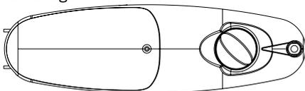
Placez-le en position médiane pour régler la température optimale pour une utilisation normale. Plus vous tournez le bouton dans le sens des aiguilles d'une montre, plus vous baissez la température dans le réfrigérateur. Plus vous tournez le bouton dans le sens contraire des aiguilles d'une montre, plus vous augmentez la température dans le réfrigérateur.
