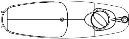
Stellen Sie ihn in eine mittlere Position, um eine für normale Verwendung optimale Temperatur einzustellen. Je weiter Sie den Regler im Uhrzeigersinn drehen, umso geringer wird die Temperatur im Kühlraum sein. Je weiter Sie den Regler gegen den Uhrzeigersinn drehen, umso höher wird die Temperatur im Kühlraum sein.
