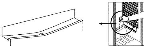
Se till att avloppsrännan och avloppsöppningen inte är blockerade så att vattnet som produceras i kylskåpet alltid kan rinna av fritt.
